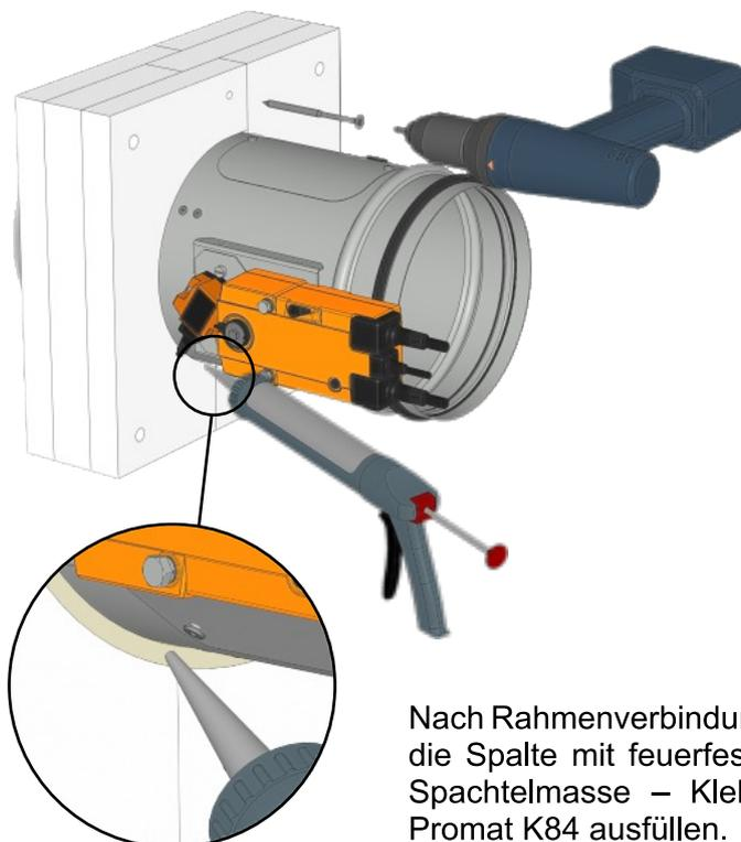
Nach Rahmenverbindung, die Spalte mit feuerfester Spachtelmasse – Kleber Promat K84 ausfüllen.
