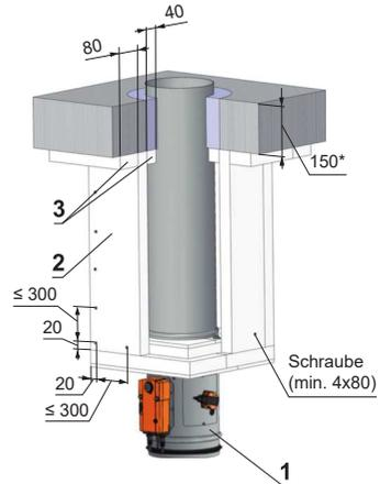
\* min. 110 - Beton / min. 125 - Porobeton
