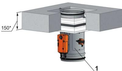
\* min. 110 - Beton/ min. 125 - Porobeton
