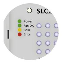
Das Gerät verfügt für jede Klappe zwei LEDs für die Klappenpositionen sowie eine Störungs-LED. Die vierte LED signalisiert die selektierte Klappe, welche direkt am Gerät getestet werden kann.
