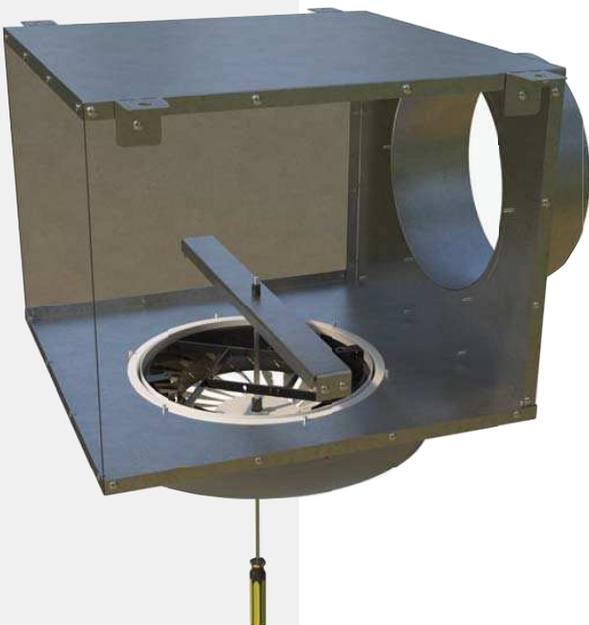
Abbildung 5 - Installation eines HSC-AD mit manueller Verstellung im Plenum via Mittelschraubenbefestigung. Geeignet für Baugrößen DN 250-500 nur mit manueller Verstellung.
